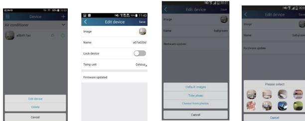
Korak 2: pritisnite "Name" da bi ste promenili ime uređaja, sačuvajte ga i novo ime uređaja će biti prikazano. Uključite dugme "Lock device" kako bi ste zaključali uređaj da drugi pametni telefoni ne mogu da ga nađu. Pritisnite "Temp unit" da promenite jedinicu temperature.
