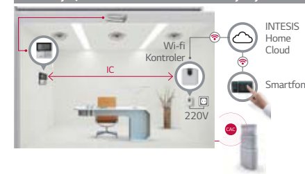
Slučaj 2) Veza sa kanalskim unutrašnjim jedinicama
