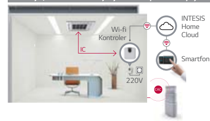
Slučaj 1) Veza sa unutrašnjim jedinicama pomoću IC prijemnika
